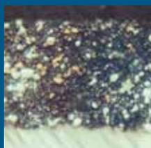
Al cabo de 7 días, se aplica una segunda capa de ZINGA® sobre la capa de polvo de oro. La capa de polvo de oro se fusiona íntegramente con cada una de las capas de producto, indicando que se ha producido una homogeneización de las dos capas de ZINGA®.
