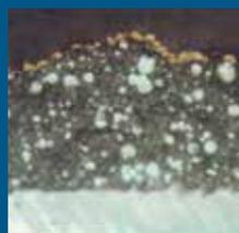
Una fina capa de polvo de oro recubre una primera capa seca de ZINGA®. El cubrimiento fue fotografiado usando un potente microscopio (µm escala).
