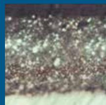
Se realiza la misma prueba con una pintura epoxi rica en Zinc. La capa de polvo dorado permanece intacta entre las dos capas de pintura. La película dorada aparece claramente visible, lo cual demuestra que las dos capas siguen siendo independientes.
