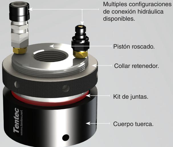
**Carga Axial en Perno:** La carga se aplica axialmente a los pernos. Inconsistencias como la fricción, flexión o lubricación no son factores que afecten al sistema MST. El stress torsional no existe.
