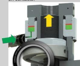
El Tensionador está presurizado al valor pre-calculado. La carga aplicada es directamente proporcional a la presión suministrada. El perno se estira y se crea una separación por debajo de la tuerca. Una vez la presión final se ha alcanzado esta se mantiene constante.
