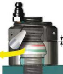
Usando la barra de arrastre gire el collar retenedor en sentido horario hasta que el cuerpo de la tuerca libere la presión. El perno está tensionado.
