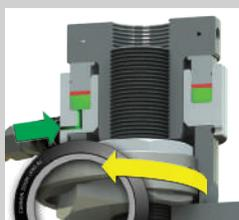
Mientras la presión se mantiene constante, se rota el giratuercas en sentido horario hasta que la tuerca haga tope con la cara de la brida.
