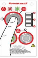
Para encender o apagar el imán (ON/OFF), pulse el botón grande del panel de control. Un LED VERDE indicará que el imán está encendido (ON).
