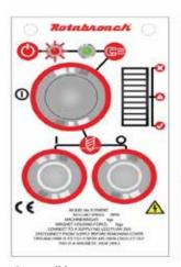
1) Encendido Cuando el taladro está conectado a la corriente eléctrica, el LED ROJO se encenderá.
