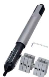
Conjunto de mandril extensible pequeño no incluye mordazas I, II, III, IV para tubería con Ø interior 38 - 86mm (1.5 hasta 3.39") Referencia: ZSP-0200-05-00-00-2
