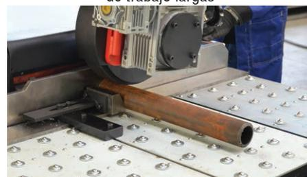
Posibilidad de biselado exterior de tubería
