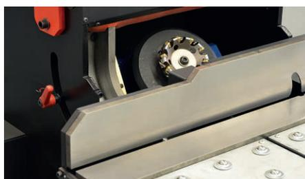
Fácil acceso al cabezal de corte y las plaquitas
