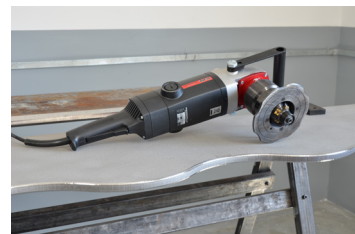
Canteado sobre borde arqueado
