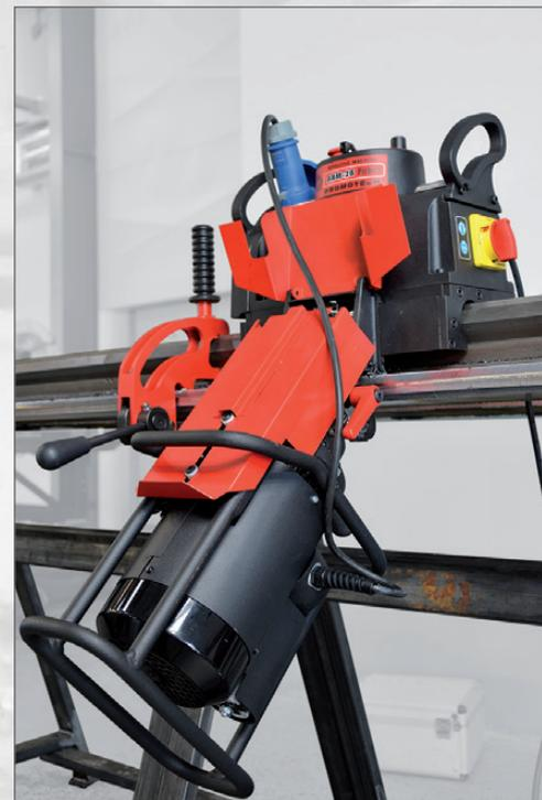
La biseladora ABM-28 puede moverse a lo largo del borde de la chapa en ambas direcciones y realizar el biselado sin fatiga para el operario.
