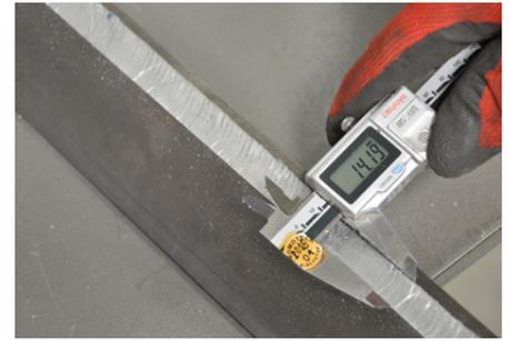
Ancho máximo del bisel hasta 14 mm
