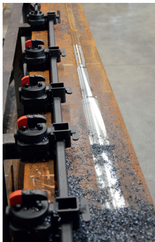
Cabezal de corte equipado con 5 plaquitas listo para trabajar
