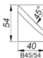
Cuchilla de Corte Bisel 45° Altura 54mm. [B45/54] Referencia: NOZ-000021
