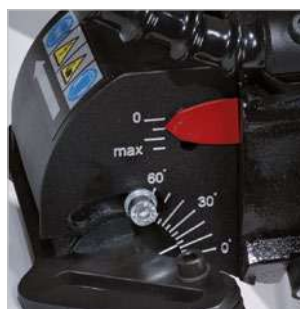
Ajuste del ángulo continuo de 0 a 60 grados.
