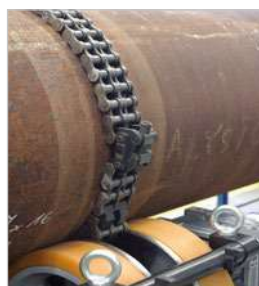
Cadena ajustable (Ø 200-1.000 mm.) asegura una rotación axial positiva
