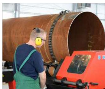
La pantalla de protección e iluminación interior aumentan la seguridad y ergonomía.
