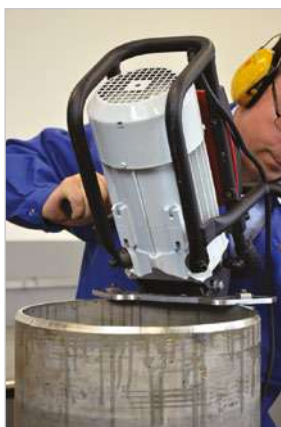
Biselado de tuberías
