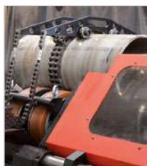
DCS-0436-99-00-00-0 Dispositivo de amarre para tubería de 400- 830 mm de longitud
