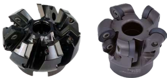
Cabezal de corte para biselado (estándar) y para biselado tipo J (opcional)
