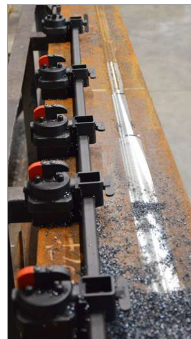
Cabezal de corte equipado con 5 plaquitas listo para trabajar
