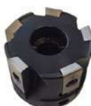
Cabezal de corte equipado con 5 plaquitas listo para trabajar
