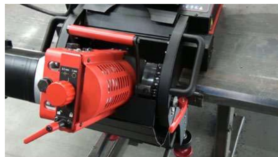
Innovador y ergonómico sistema de ajuste del ángulo de bisel con palanca de desbloqueo que no requiere herramientas adicionales
