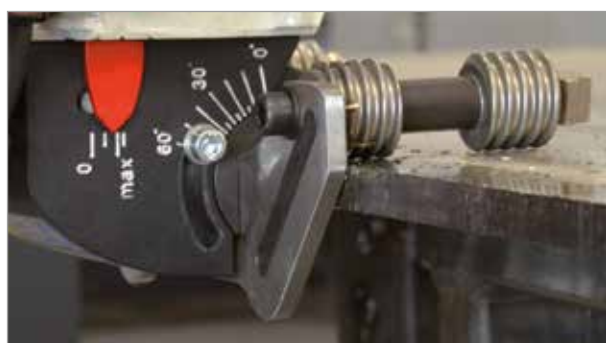
Ajuste continuo del ángulo de 0 a 60 grados
