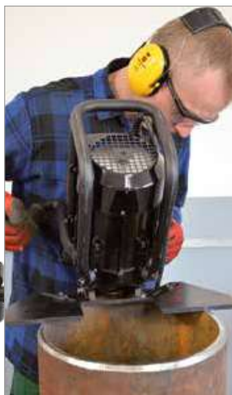
Biselado de tuberías
