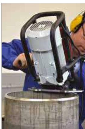
Biselado de tuberías
