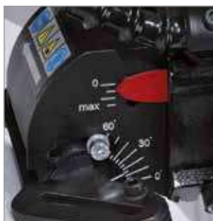
Ajuste del ángulo continuo de 0 a 60 grados
