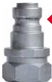
*Desgaste en espiga causado por las bolas de seguridad del acoplamiento.*
